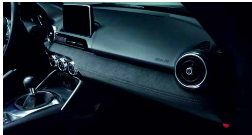
Panneau de porte inférieur, panneau de bord, soufflet de frein à main, soufflet de levier de changement de vitesse
