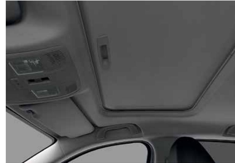
Toit ouvrant électrique (sauf sur Skyactiv-D 150 ch)
