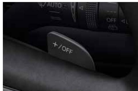
Palettes au volant pour le réglage du freinage régénératif
